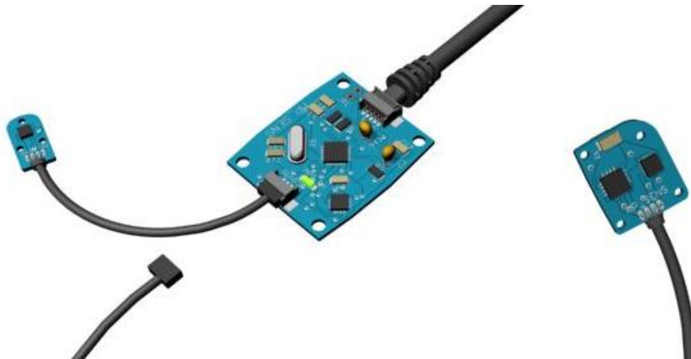
Figura 4.34 Perspectiva 3D de placa controladora y adaptadores de sensores, para subsistema externo de accesibilidad.
