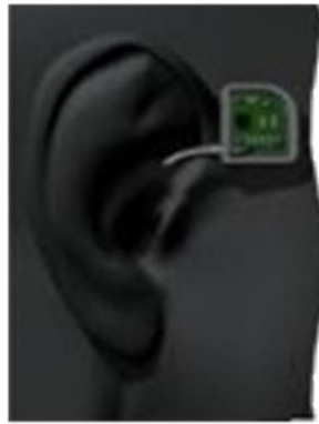
Figura 4.42 Diagrama de instancia intermedia hacia la propuesta de prótesis para detección de movimientos de cabeza, con placa dedicada para adquisición de sensores de movimiento
