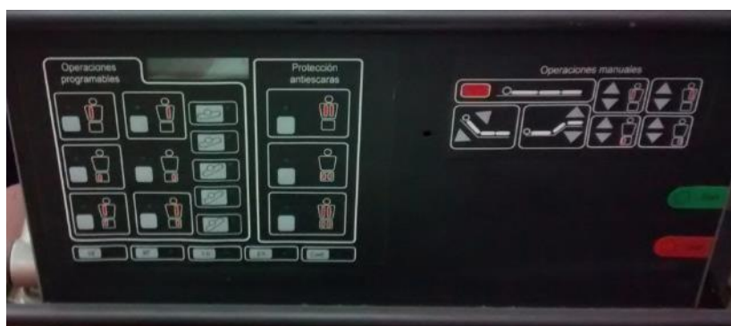
Figura 3.5 Panel frontal para control de cama mecatrónica original, desarrollada por el grupo de investigación del CIDI-FADU-UBA. Se observa la diversidad de comandos y funciones del equipo
