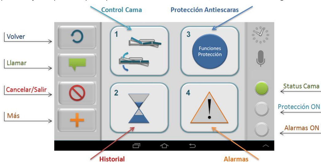
Figura 4.49 Sección de pantalla principal propuesta para interfaz gráfica. Recurre a mecanismos de señalización semejantes a los encontrados en mandos de laterales para las opciones principales, con íconos grandes que derivan en las distintas formas de configurar el equipo.
