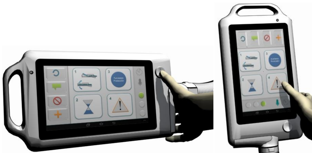
Figura 4.52 Alternativas de uso de la interfaz bidireccional: Pantalla táctil e interruptores, en orientaciones apaisada y vertical (esta última no implementada).
