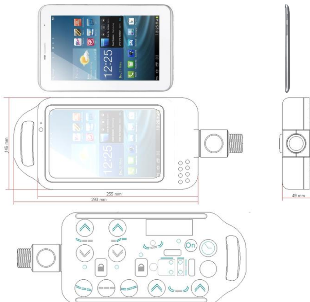
Figura 4.6 El concepto de la estructura toma un dispositivo portable como punto de partida (arriba). A partir de éste, la definición del soporte externo inicial, para la distribución de mandos y otros periféricos, fue ajustada a los requisitos del sistema 3
