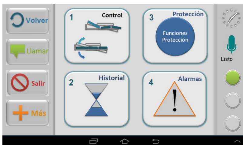
Figura 4.55 Interfaz robusta de accesibilidad para control con puntero y voz: captura de pantalla de menú principal con interruptor adicional para activación mediante comandos de voz, y con indicadores de comandos en cada opción.
