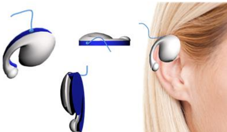
Figura 4.43 Perspectivas 3D y Montaje de vista lateral de prototipo para adquisición de movimientos de cabeza
