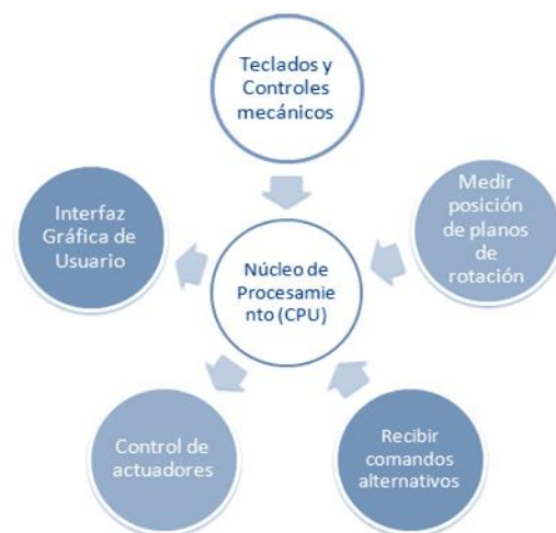
Figura 4.1 Estrategia de control para la versión actualizada de la cama mecatrónica indicando, en forma esquemática, sus funciones básicas.
